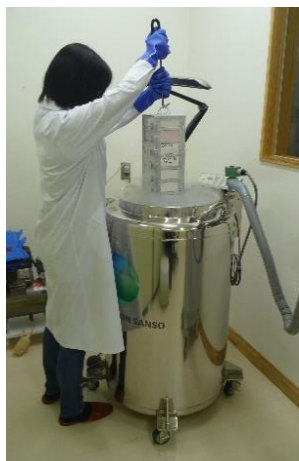
左写真. 気相式凍結保存容器. 庫内は -170^{\circ}\text{C} に保たれている.
