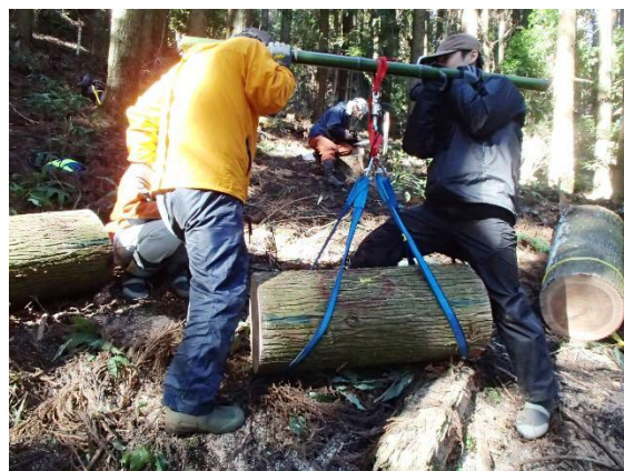
材質調査 (動的ヤング率測定)
