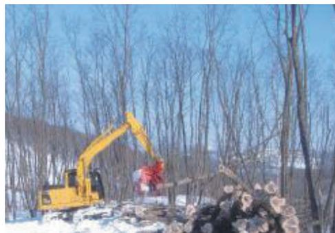
フェラーバンチャを用いた冬の造材作業
