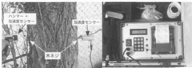
写真-1 ストレス波速度計測装置
