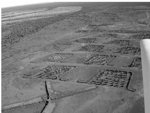
図-4 植栽サイトの全景。手前から奥にかけて緩やかな下り傾斜となり、降水がバンクによって捕集される。ダイナマイトによってハードパンを破碎し、植穴を造成した(SC1-2区を除く)。
