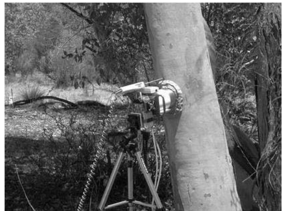
図-5 E. camaldulensis の幹呼吸速度の測定。Li-6400土壌呼吸用チャンバーを幹呼吸測定に応用した。
