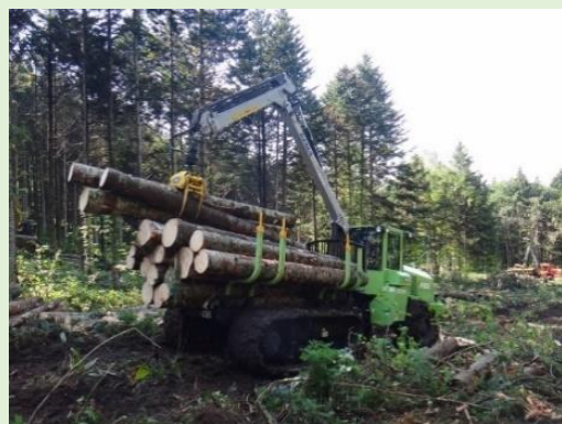
ベースマシンが油圧ショベルのハーベスタとハーフトラックの高速フォワーダ
