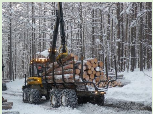
林業専用機 PONSSE 社 ハーベスタ BEAVER とフォワーダ GAZELLE による伐採作業
