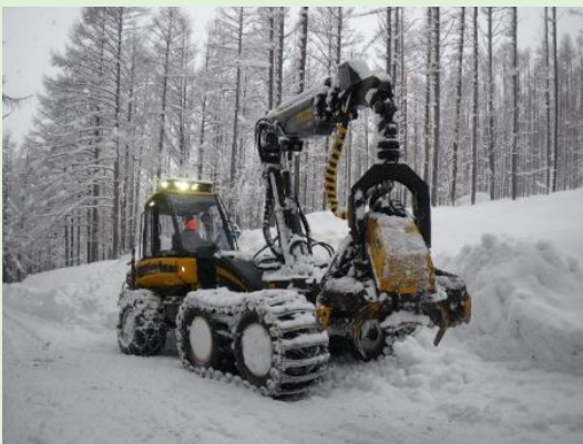
林業専用機 PONSSE 社 ハーベスタ BEAVER とフォワーダ GAZELLE による伐採作業
