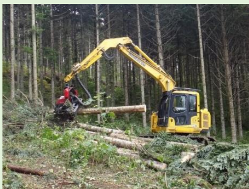
ベースマシンが油圧ショベルのハーベスタとハーフトラックの高速フォワーダ
