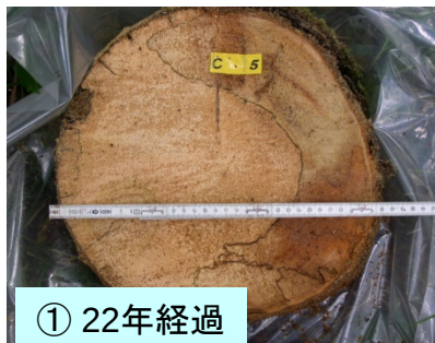
写真 チェーンソーで倒木を切断し、切断面の様子を観察（樹種:エゾマツ）
