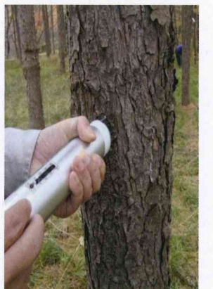
写真-1 ピロディンForest 6Jによるピロディン陥入量の測定
