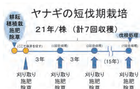
図-2 ヤナギの短伐期栽培計画。最初の1年で根付かせ、台切り後の萌芽枝から生産を開始する。現状、同株から7回21年間の収穫を目指す。
