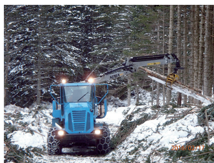
図-1 フォワーダによる集材作業
