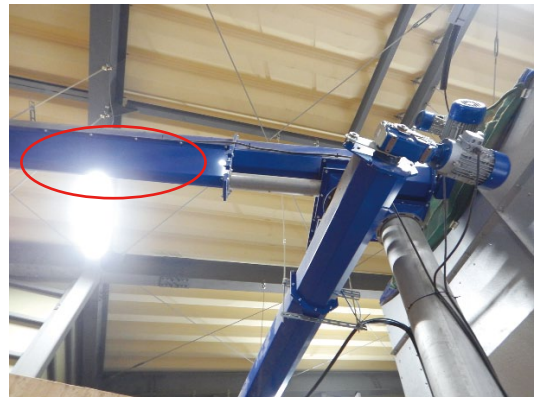
写真3 コンベアがメッシュ状になっており、振動を与えることで微粉を除去する装置
