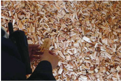
写真2 小規模CHP装置で用いる燃料チップ
