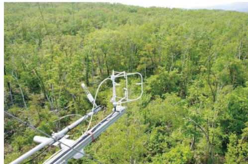
写真1 27mの高さに取り付けられた測器。 渦相関法に用いるため、1秒間に10回、二酸化炭素濃度や風速を測定している。
