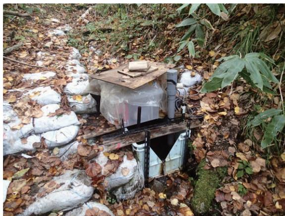
写真－1 流域末端に設置した流量観測施設
