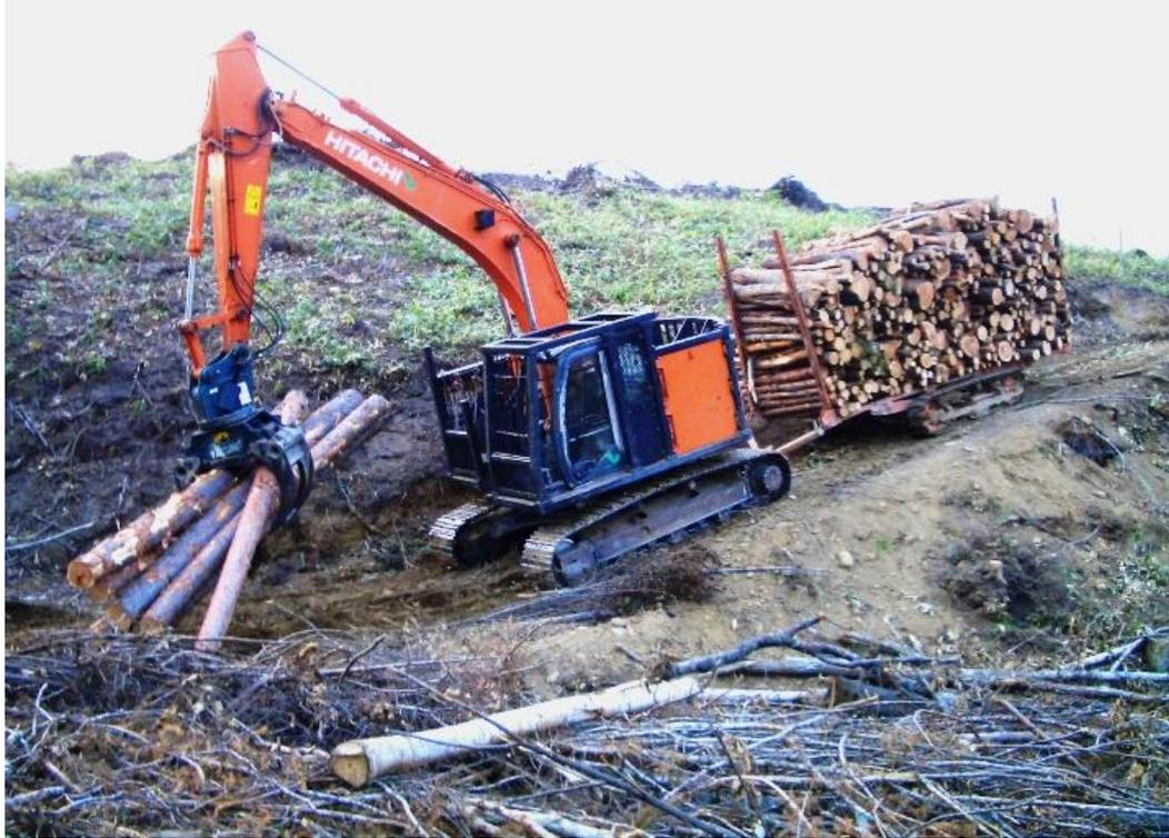
写真-5 クローラカートによる短幹集材
