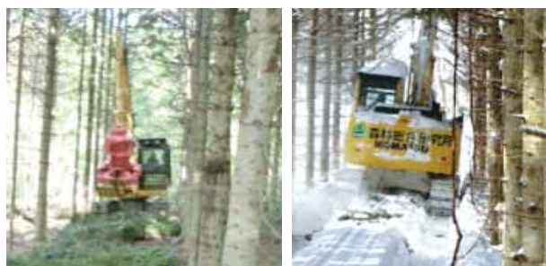
図－1 無雪期の狭い幅（左）と積雪期（右）の走行試験の様子
