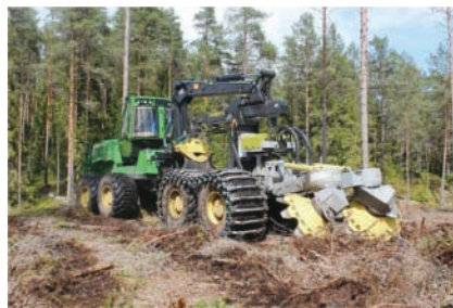
写真 フォワーダベースのマウンドによる地拵え (スウェーデン南部ヨンショーピン市近郊にて)
