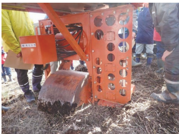
写真-4 自動植付機のバケット（左）とコンテナ苗植栽ユニット先端部（右）
