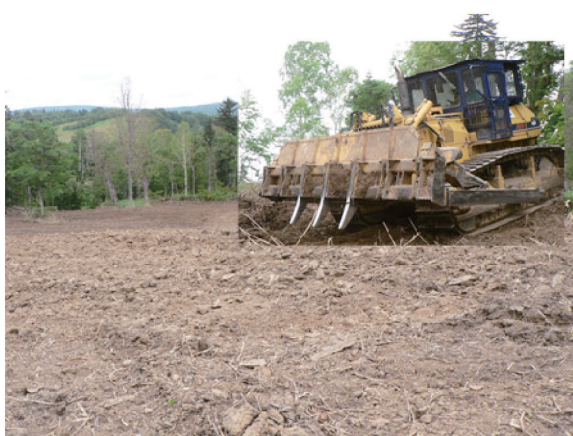
図2 従来法の地がきを行った林地と、地がきに使った機械
