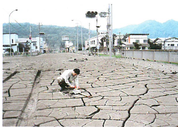
写真2 泥流堆積物採取状況 (図1の(2)地点)
