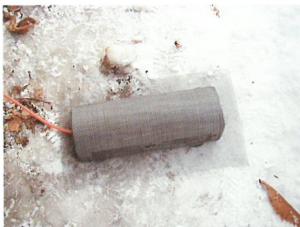
写真－3 穴やスリットをあけた塩ビ管を地表面に固定し、CO 2 センサを挿入した
