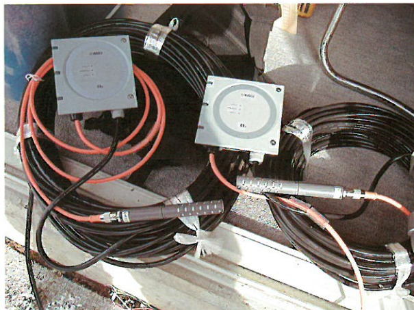
写真－2 CO 2 濃度計。筒状の部分がCO 2 センサ
