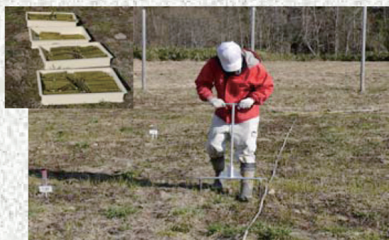
50cm間隔に2本の挿し棒がついた植栽穴開け器
