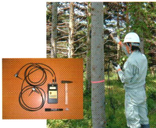
ファコップとファコップによる測定風景 立木のままで効率的に材質の調査ができる。
