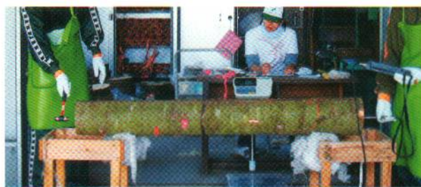
木を切り倒し丸太にしての測定風景 伐倒木の丸太の一端をハンマーで打撃し、打撃音をFFTアナライザーにより解析して材質を調査する。
