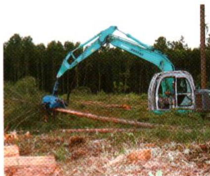
高性能機械で伐倒から集材までを処理
