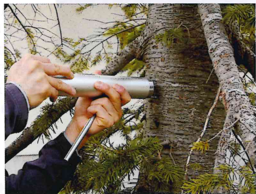
写真1 ピロディンの測定
