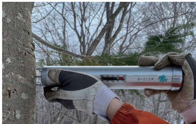
図-2.ピロディンによる試験風景
