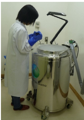
写真1. ブナ種子などの林木遺伝資源が保存されている凍結保存容器。内部は液体窒素によって冷却され、 -160^{\circ}\text{C} 以下に維持されている。
