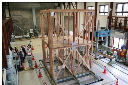
2 階建て木造在来工法建築物の耐震実験
