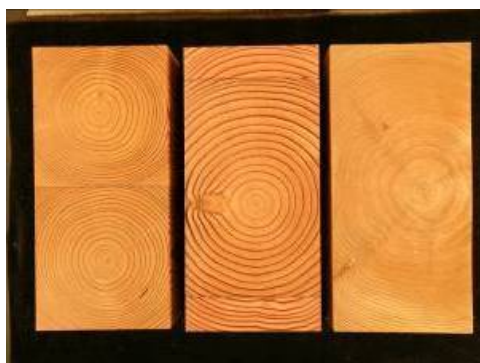
写真 接着重ね梁と無垢材の断面
