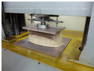
図2 最大荷重(左)と色彩色差(右)の測定
