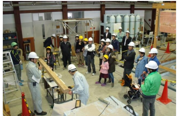
写真1 スギ柱材の強度試験
