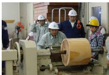
写真8 スギ丸太の桂剥き
