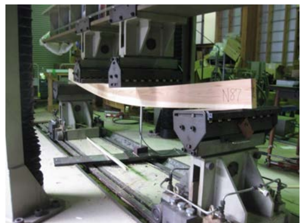
写真 スギツーバイフォー (206) 材の 曲げ強度試験 (長野県林業総合センターにて)
