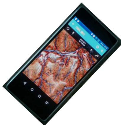
図2 スマートフォンを用いたCS 立体図の表示
