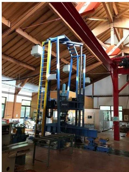
図2 1,000KN 実大強度試験機
