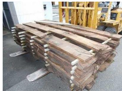
写真 3 熱処理後の板の様子
