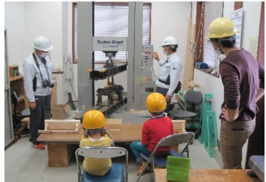
写真1 公開実演：スギ材の曲げ試験
