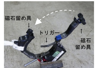
写真 1 自動装着型 GPS 首輪
