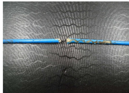
図6 噛み切られた弾性ポールの切断面
