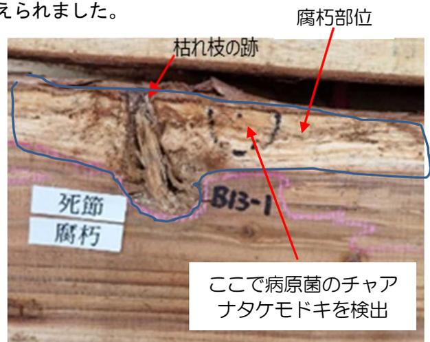
図1 枯れ枝の跡から腐朽が進行している様子
