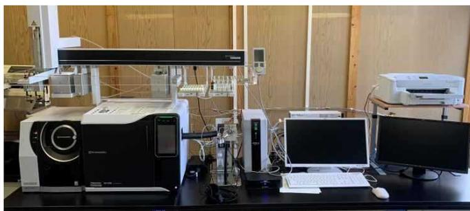
写真4 ガスクロマトグラフ質量分析装置
