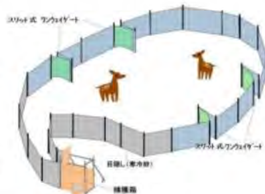
図2 シカ侵入防止柵に併設した スリット式ワンウェイゲートイメージ図
