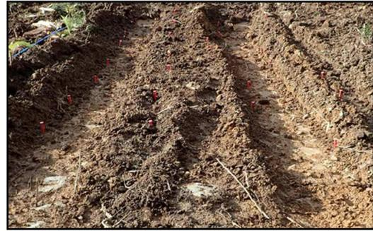
写真2 機械の走行直後の地表面の状態（10回区）
