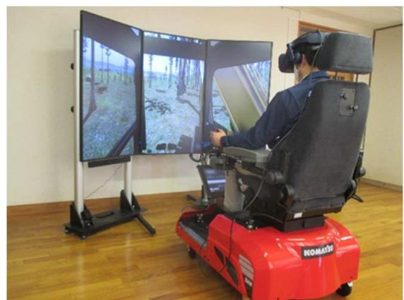
写真3 高性能林業機械シミュレータ
