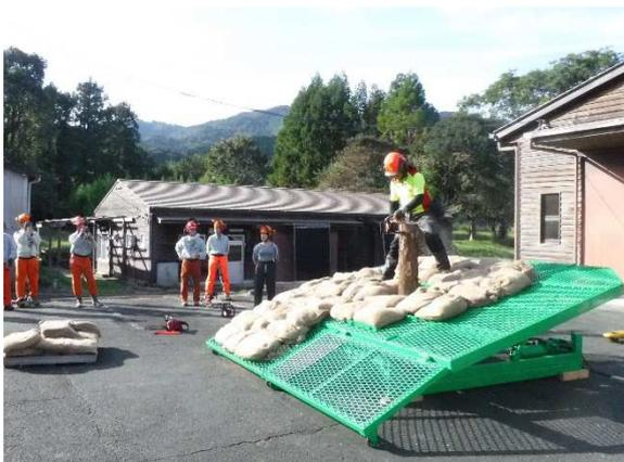
写真2 傾斜機能付き伐倒練習機
