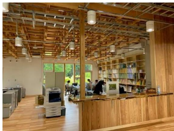
木造であることを建物の外観からもアピールするために、入り口側には大きな窓（左）を設けることで、採光しつつ、外からも構造（右）が望めるように設計されています
