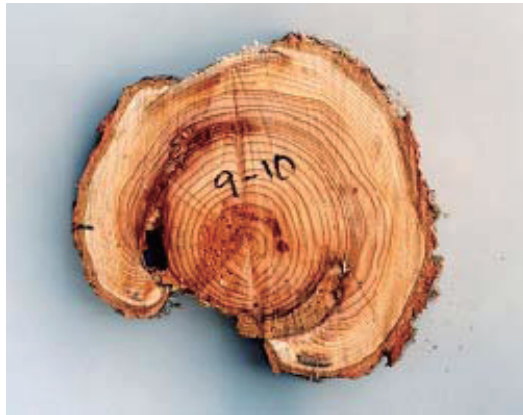
写真－３ 残存木損傷部分から発生した変色・腐朽
