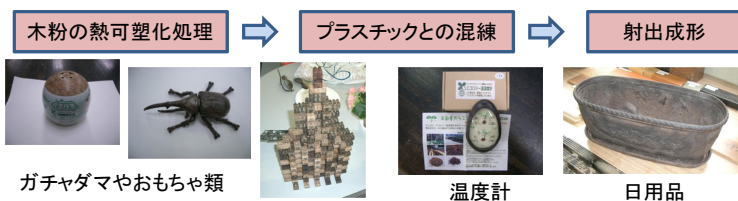
図 4 木質高充填複合プラスチックによる石油系プラスチック代替
