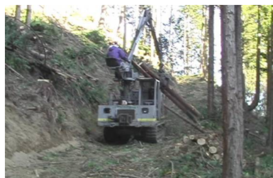
作業路脇に整理された丸太をフォワーダで林道まで小運搬
