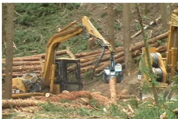
集材木がまとまった段階でプロセッサによる造材
