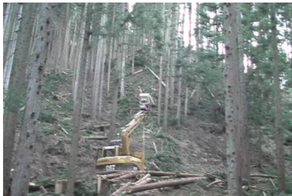
伐採列に索張りして下げ荷による集材
