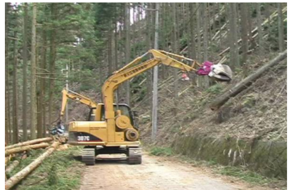
集材が終わりこのあとヘッド(ザウルス)で集材木を整理する。林道脇の電線が作業能率を落としている。
