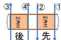
図-1. 太鼓材から正角を製材する鋸断順
