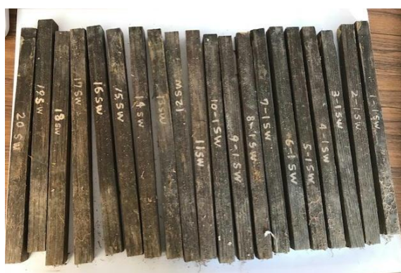
図-4 腐朽促進試験開始後18ヶ月の熱処理材
