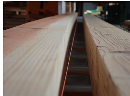
写真1 左：製材直後に発生した矢高（2丁取り） 右：処理後に矢高が矯正された製材
