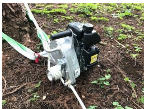
写真1 ポータブルロープウインチ
