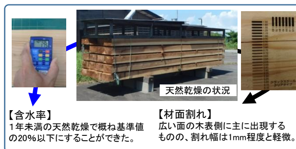
図2 乾燥後の含水率と材面割れの確認
