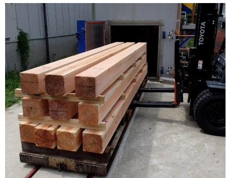
写真2 4丁に小割り製材する前の蒸煮処理
