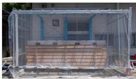
写真-2 ガラスハウスによる太陽熱乾燥
