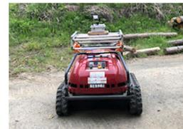
FPVカメラユニットを搭載した自走草刈機
