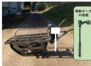
作業アタッチメントによる植栽作業補助
