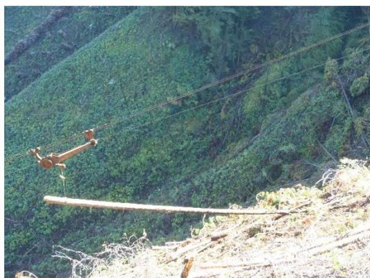
図1 集材機による架線集材の様子
