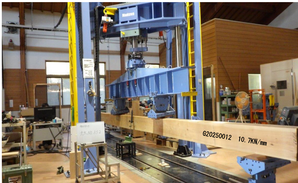
図 1 曲げヤング係数の測定試験
