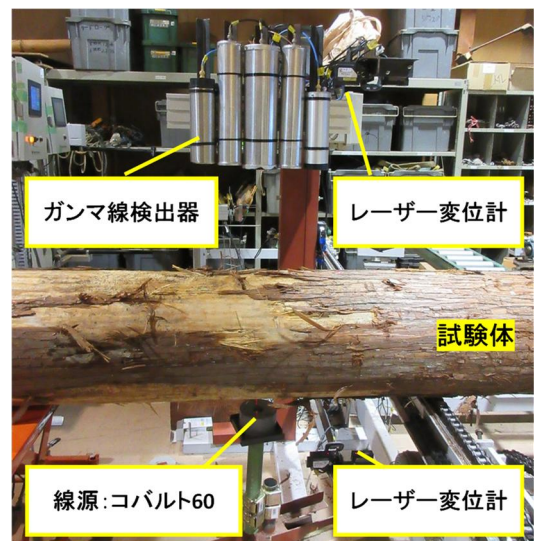
図 2 ガンマ線測定装置
