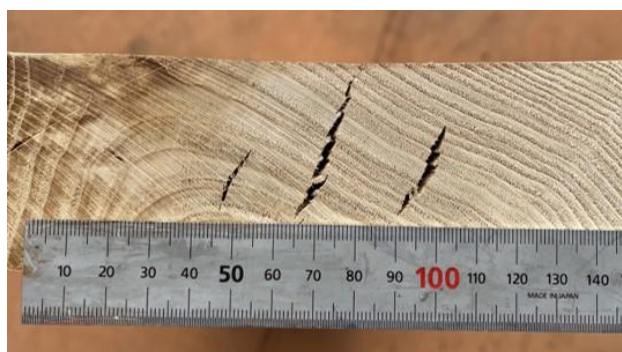
図-1 クリの試験体に発生した内部割れ
