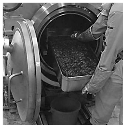
図1 樹皮の蒸煮処理
