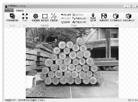
図-2 原木材積計測システム
