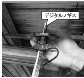
写真-3 ノギスによるたわみ測定（測定点約 50）
