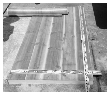
写真-1 県産材パネル型枠
