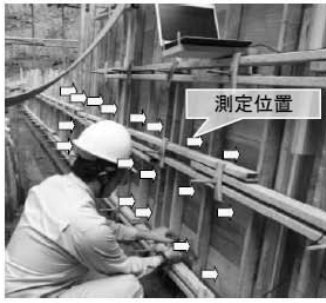
写真-3 ノギスによるたわみ測定（測定点約 50）
