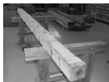
写真4 材長倍が最大の柱
