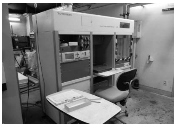
写真2 コーンカロリメーター
