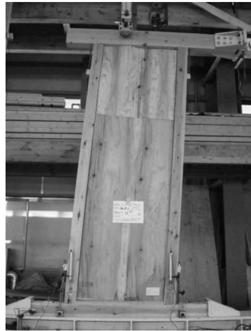
写真1 面内せん断試験の状況
