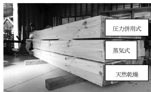
写真-1 乾燥方法別の代表的な試験体
