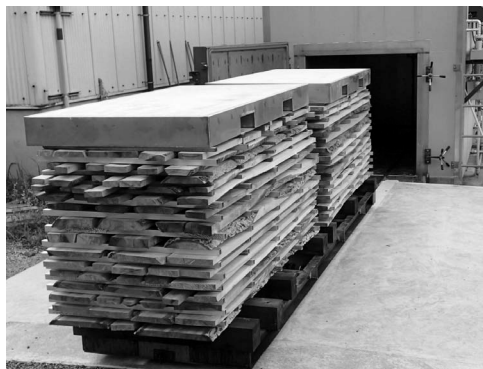
写真3 アベマキ材の人工乾燥
