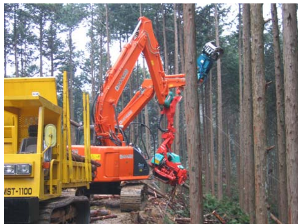
スイングヤーダ・プロセッサ・フォワーダによる搬出作業
