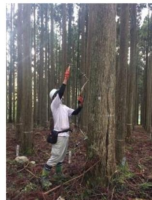
写真 FAKKOP を用いた応力波伝播速度の測定
