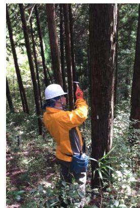
写真1 応力波伝播速度の測定
