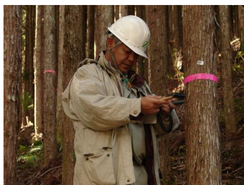
FFT アナライザーによる測定
