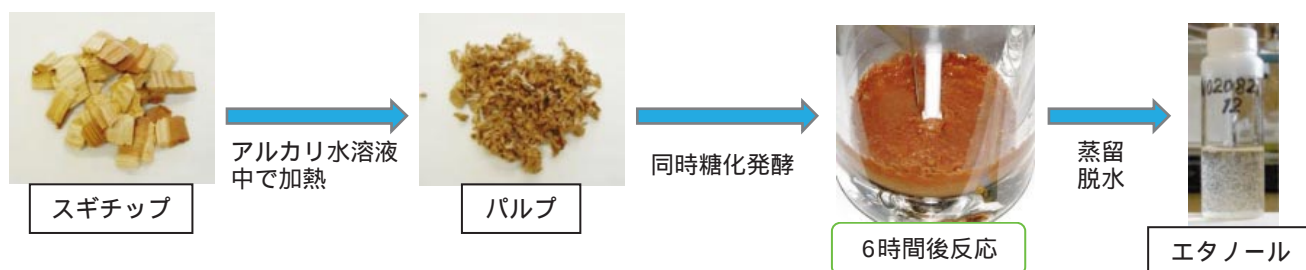
図6 アルカリ前処理と同時糖化発酵による木質バイオマスからのエタノールの製造工程
