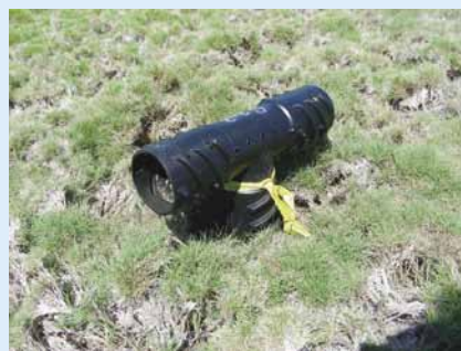
写真2 西島に設置したベイトステーション 内部に殺鼠剤を入れた筒状の餌置き場を設置し、鳥類など非標的種の誤食を防ぐ。
