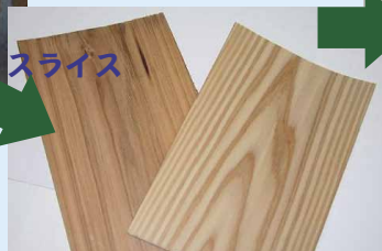
写真2 木材をスライスして 製造した単板
