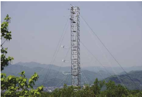
森林内にタワーを設置し二酸化炭素（CO 2 ）吸収量を測定しています
